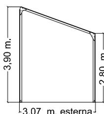
Struttura modulare costituita da portali a singola falda realizzati in alluminio e tamponamenti in pvc con reazione al fuoco cl.2.
