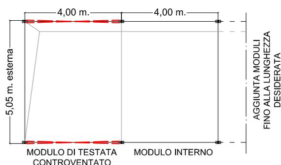
Struttura modulare costituita da portali a singola falda realizzati in alluminio e tamponamenti in pvc con reazione al fuoco cl.2.
