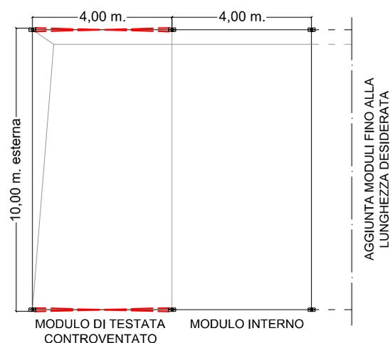
Struttura modulare costituita da portali a singola falda realizzati in alluminio e tamponamenti in pvc con reazione al fuoco cl.2.
