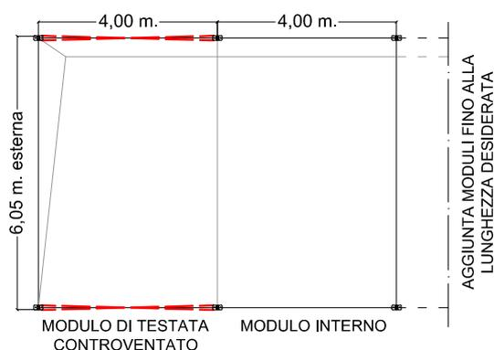
Struttura modulare costituita da portali a singola falda realizzati in alluminio e tamponamenti in pvc con reazione al fuoco cl.2.
