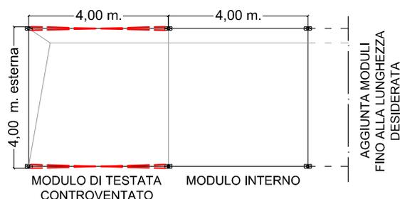
Struttura modulare costituita da portali a singola falda realizzati in alluminio e tamponamenti in pvc con reazione al fuoco cl.2.
