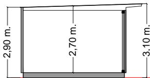
Copertura con struttura portante in legno lamellare a vista, vetrata di ingresso con serramento scorrevole, chiusure laterali in pannello in lamiera preverniciata coibentata. Tetto con pannelli e travatura in legno multistrato a vista e impermeabilizzazione esterna tramite membrane in pvc.
