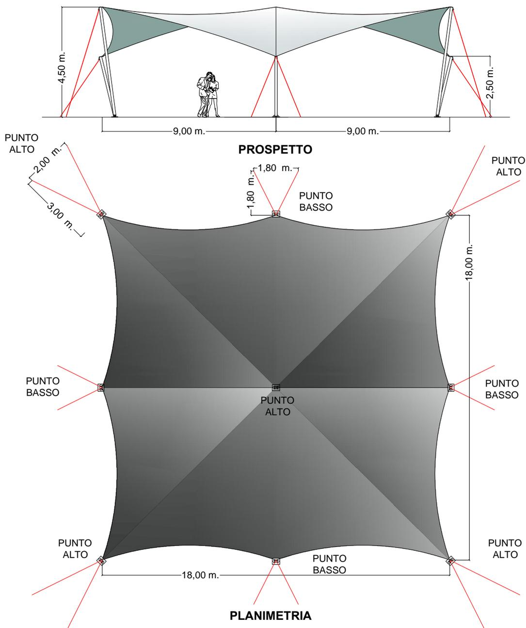
Tensostruttura a vela realizzata con membrana impermeabile in pvc spalmato, ignifugo ad alta resistenza.
