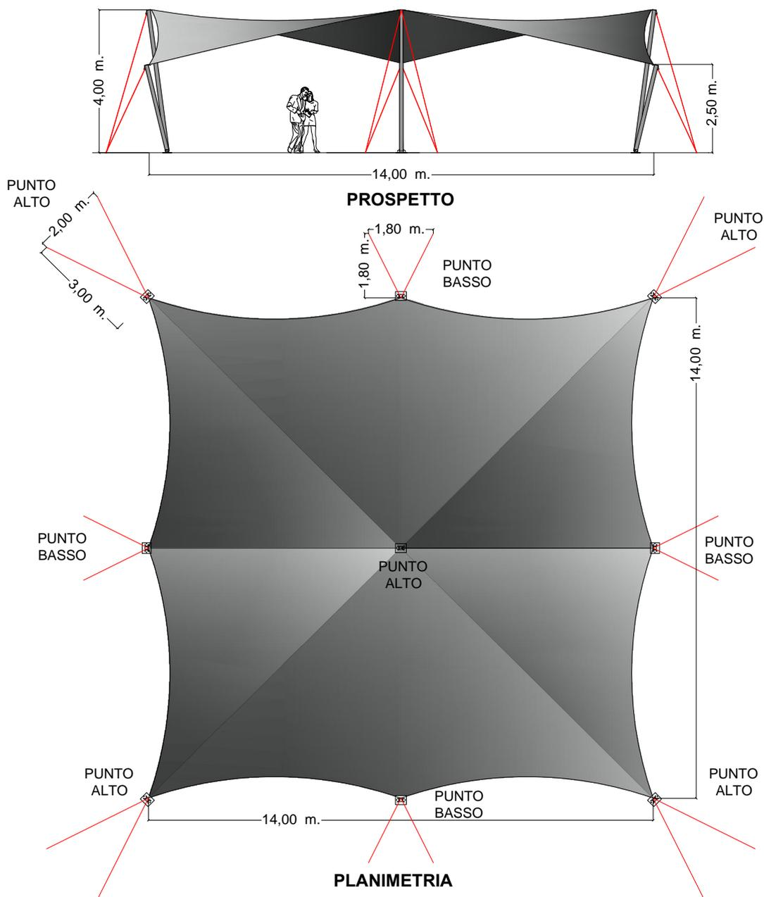
Tensostruttura a vela realizzata con membrana impermeabile in pvc spalmato, ignifugo ad alta resistenza.
