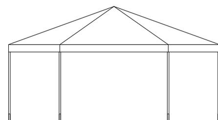
Il modulo testata ad abside è compatibile per i padiglioni classici e ne sostituisce la testata terminale rendendo il design della copertura più armonioso e gradevole. L'inclinazione della falda viene mantenuta costante garantendo un buon deflusso delle acque piovane.
