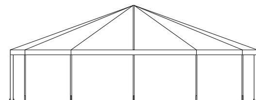
Il modulo testata ad abside è compatibile per i padiglioni classici e ne sostituisce la testata terminale rendendo il design della copertura più armonioso e gradevole. L'inclinazione della falda viene mantenuta costante garantendo un buon deflusso delle acque piovane.
